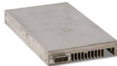
Fig. 2: 1 kW L-Band SSPA Module
